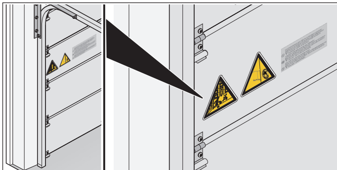
Fig. 1.2 Sette på klistermerker på portbladet
